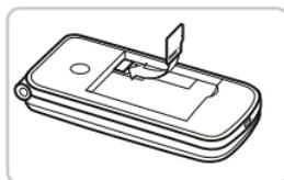
1. Entfernen Sie den Akku-Deckel (Ausnehmung links unten).
